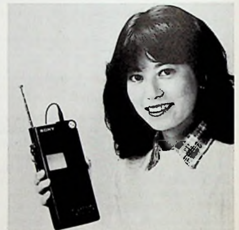
Bild 2: Der Taschenfernseher mit Flachbildröhre braucht nur 1,8 W (Sony-Presebild)
