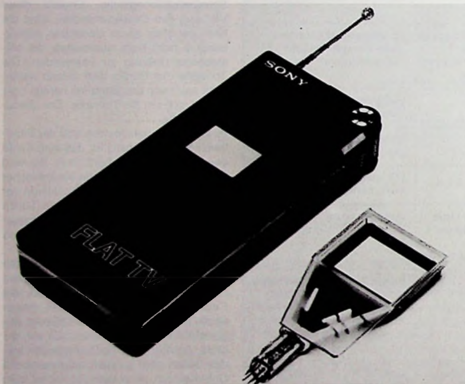
Bild 1: Nur 16,5 cm dick ist die neue Flachbildröhre (Sony-Presebild)
